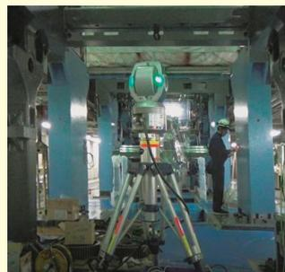
製品の品質を維持していく上で、測定や確認を行う作業は今後ますます重要になります。接触型の三次元測定機では測定困難な大型の構造物も西研グラフィックスが所有するレーザー式三次元測定機を使えば測定が可能で高精度な測定サービスも行っています。
