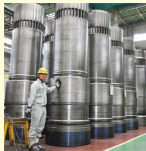
内径600ミリメートル以上の大型部品では国内で7割超、海外で3割超のシェアを誇る東亜工機のシリンダライナ。高い強度と精度に寄せられる信頼は厚く、メーカーは届いた製品をそのままエンジンに組み込めるほど。不良品を出さない確かな技術が、海上の安全を支えています。
