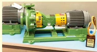
軸の回転による、遠心力で中の液体を流動させるポンプ。その軸を動かすモーターの必要電力は、日本の使用電力の約3割に上ります。高効率にこだわったエコポンプは約10%の電力費とCO<sub>2</sub>の削減を達成。その取組が評価され、平成26年度(2014年度)には経済産業省の省エネ大賞を受賞しました。
