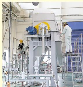
昭和62年(1987年)に完成した“CD(コンパクト・ディスク)ドライヤー”は、産業廃液などを高熱の円盤に当てて蒸発させ、乾燥処理する仕組みで、発売以来500台以上を売るロングセラー製品。主要部品のみを輸出し、アフターサービスを現地企業に任せる戦略で海外展開も進めています。
