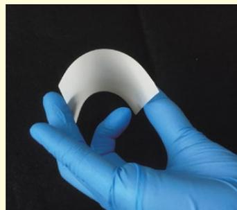
共立エレクトクスの“超薄厚みセラミックシート”は、強度を保ちつつ靱性も有しており、その成形技術は非常に高いと評判です。薄型化が進む電子部品や燃料電池、全固体電池などさまざまな用途開拓が進んでいます。
