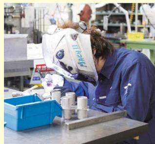
金属加工の中でも、特に溶接加工の評価が高い中島製作所。技術が必要とされるステンレスの薄い板同士の溶接を得意としています。5年、10年と経験を積んだ職人たちが高い水準で行っており、お客さまから“仕上がりがきれい”と好評価を得ています。
