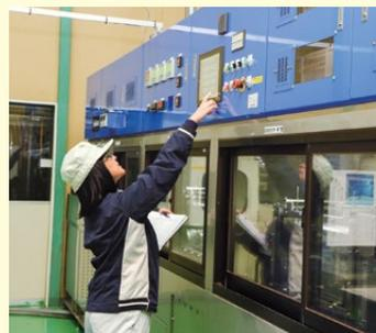
超音波洗浄機“AQUAPASS”の洗浄では、フロンなどでも落とせない指紋を水だけで落とすほどの脱脂力と微粒子除去能力を発揮します。スマートフォンや電子精密機器の中にある部品の洗浄には欠かせない存在になっています。
