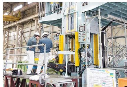
※1 ファインブランキング：抜き打ち加工を精密に行うプレス加工技術
