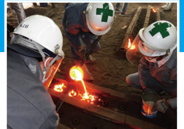
1400℃で溶かした鉄を型に流しています(鑄造実習)
